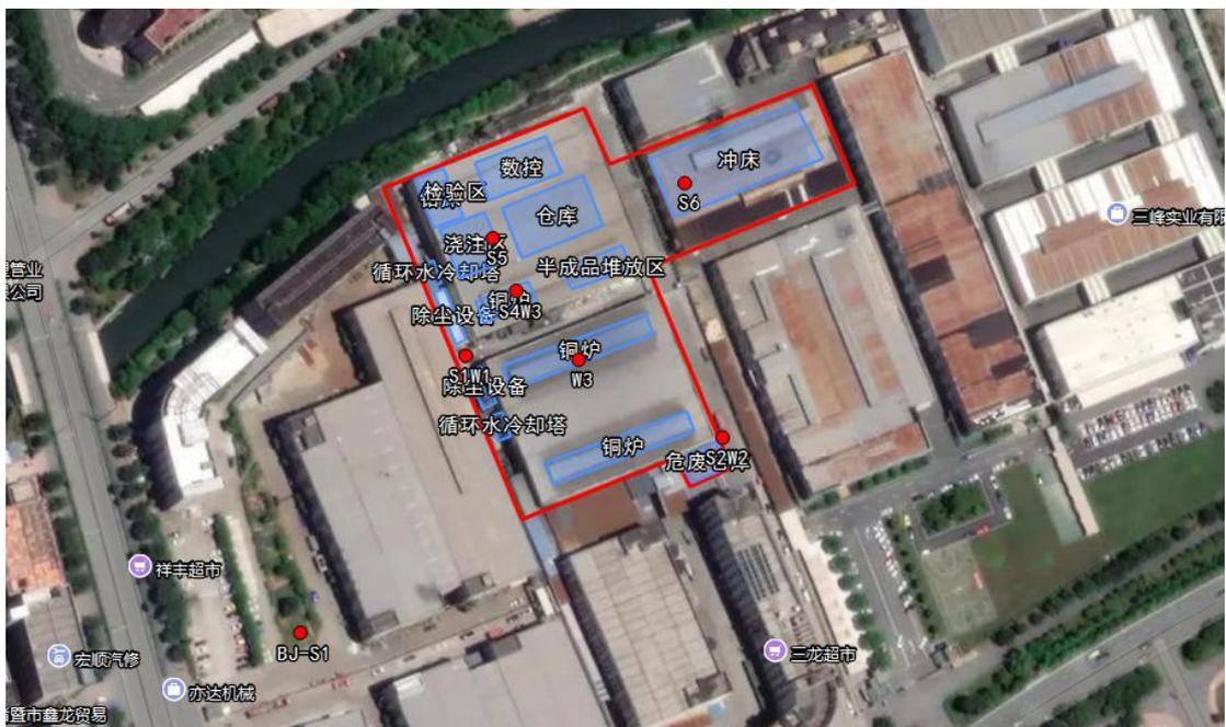
图 3.2-1 土壤监测点位布设示意图
